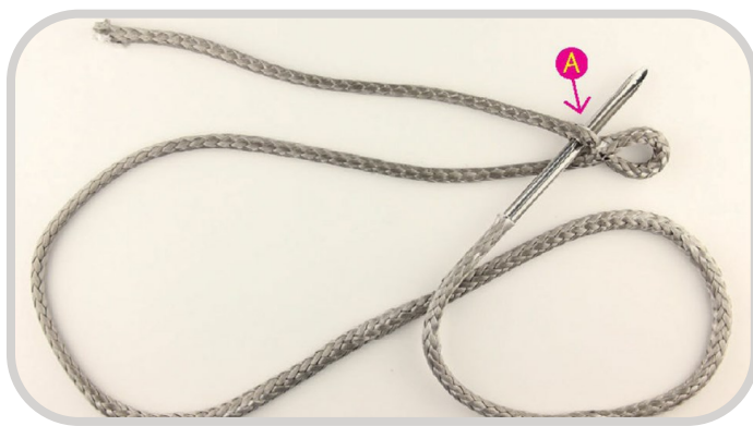
6 žingsnis—Praverk ilgąjį virvės galą, kol jis bus visiškai praverintas ir įtempk, kad kilpa iki galo susiformuotų.
